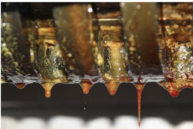
Bild 2: Schneckenpresse zur Gewinnung von kaltgepresstem Kürbiskernöl
